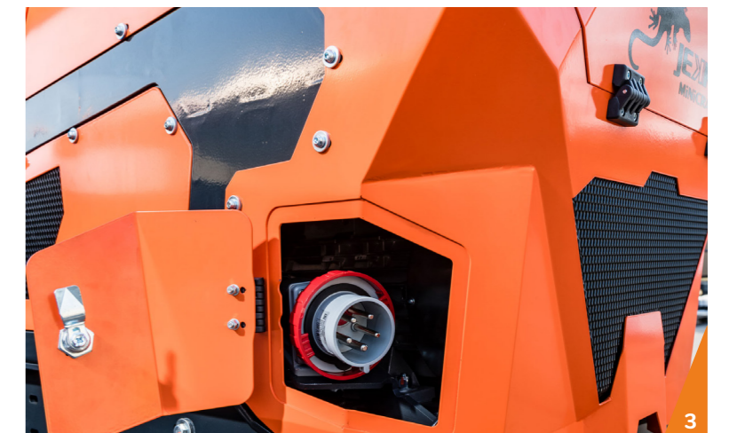
1 De Jekko SPX 1280 in transportstand. 2 Alle functies zijn vanaf de radiografische bediening te gebruiken. 3 Het is mogelijk om met deze machine op stroom te draaien.
