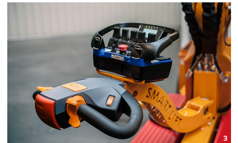
1 De SL1008 wordt ingezet voor het plaatsen van zware ruiten. 2 De SL1008 heeft standaard een roteerbare kop. 3 Montagefuncties worden bedient vanaf de radiografische afstandsbediening.
