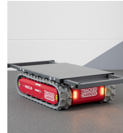
Het platform is uitschuifbaar tot een lengte van 1.91 meter.
