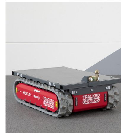
Met de trekhaak is het mogelijk een aanhangertje te verplaatsen of goederen te verslepen.
