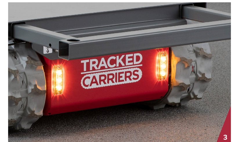
1 De rijnsnelheid van deze transport carrier is 3,5 km/h. De rupstracks zijn afzonderlijk van elkaar te besturen. 2 Op de achterzijde van de transport carrier zijn enkele machinespecificaties te zien 3 Het platform is uitschuifbaar tot een lengte van 1,60 meter.
