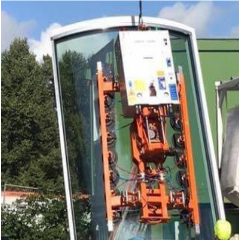
1 Glazen loopbrug monteren op project Valley te Amsterdam 2 Door gebruik van 280 mm pads toepasbaar voor zowel recht- als gebogen glas 3 Al onze glaszuigers zijn inzetbaar in combinatie met een evenaar
