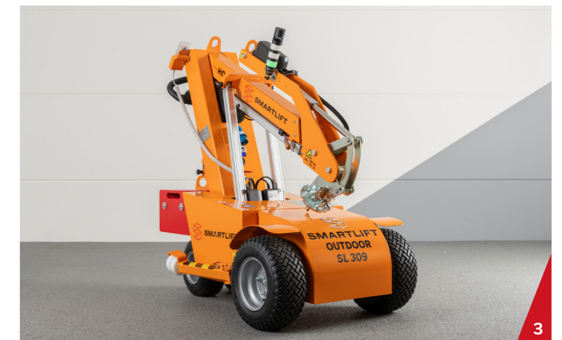
1 De functies van de SL309 zijn te bedienen vanaf de handbediening. 2 De stuurarm is opklapbaar voor extra compactheid. 3 Na het verwijderen van het zuigerframe en het opklappen van de arm is de SL309 de meest compacte Smartlift.
